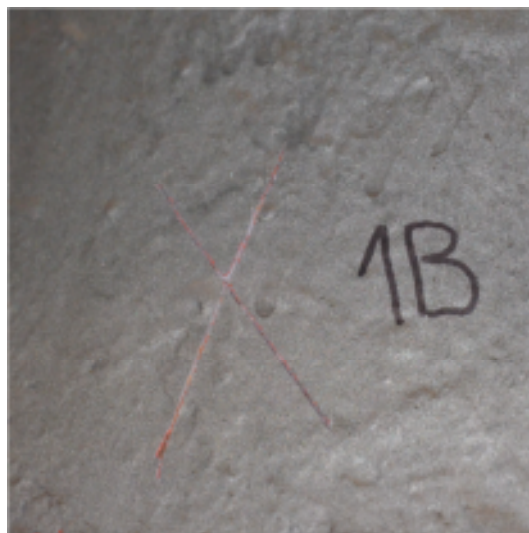
Obr. 21 Hodnocení přilnavosti, X řez, stupeň 0
