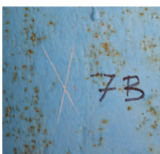
Obr. 25 Hodnocení přilnavosti, X řez, stupeň 0
