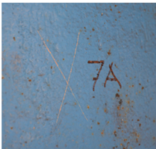
Obr. 24 Hodnocení přilnavosti, X řez, stupeň 0
