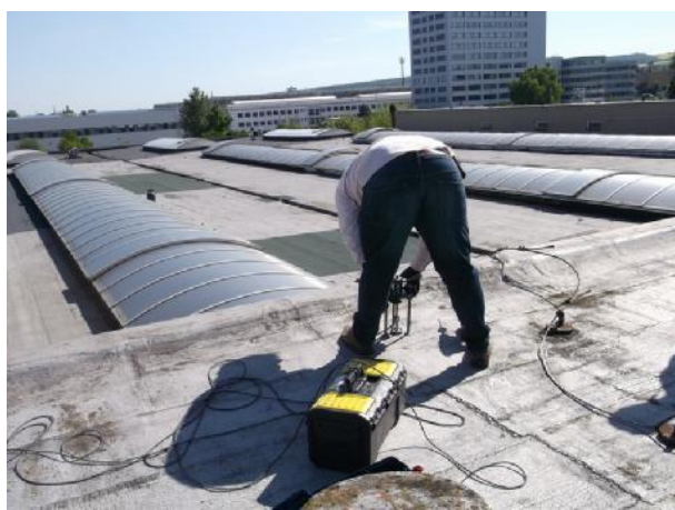
Odtrhové zkoušky střešního pláště (5/2015)
