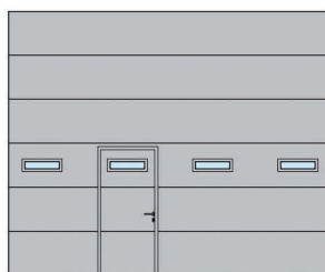
Lamelové okno, typ D umístění integrovaných dveří vlevo
